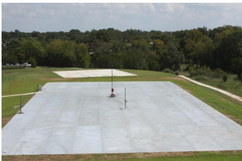
Рис. 1. Испытательная площадка для калибровки антенн на примере CALTS, развёрнутой в ETS-Lindgren, Сидар-Парк, Техас, США
