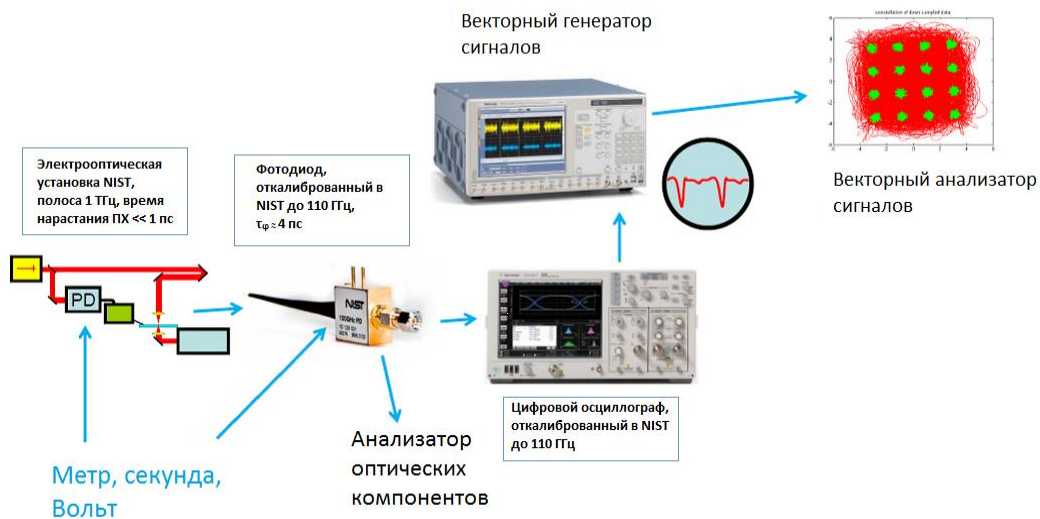
Рис. 2. Прослеживаемость измерений параметров цифровых модуляций в NIST
