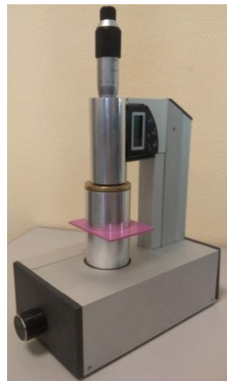
Рис. 5. Щелевой резонатор 23–35 ГГц
