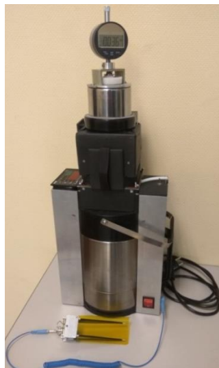
Рис. 4. Криостат с резонатором 13–16 ГГц для плёнок при температуре от -60 до +70 °С
