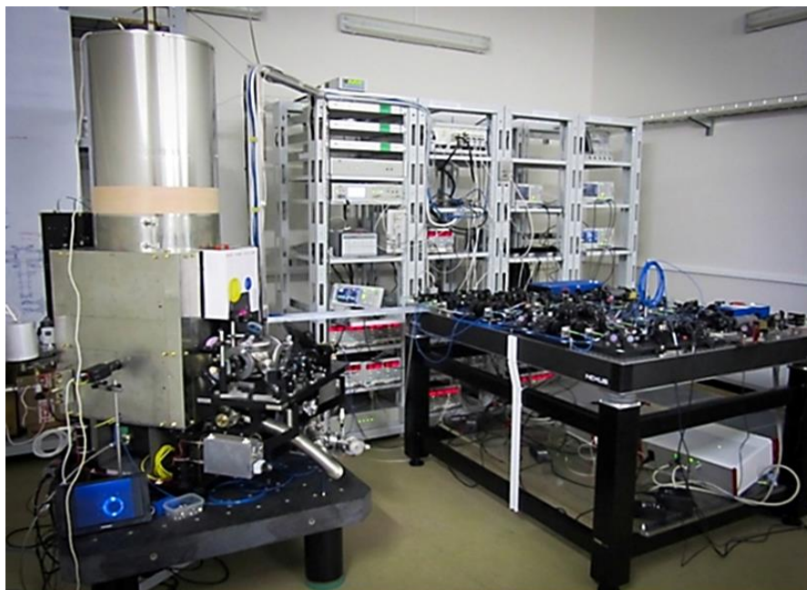
Рис. 6. Хранитель единиц времени и частоты на основе «фонтана» атомов рубидия
