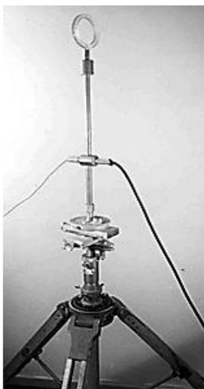
Рис. 1. Излучающая рамочная антенна из состава УОП-0.012-50
