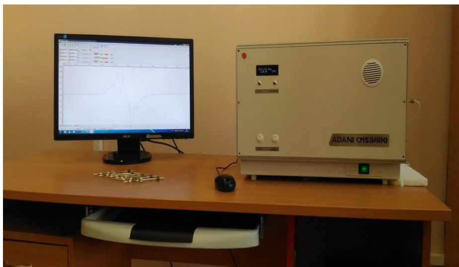
Рис. 2. Относительный ЭПР-спектрометр ОПС-2 (компаратор)
