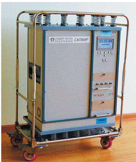
Рис. 1. Перевозимые квантовые часы водородные
