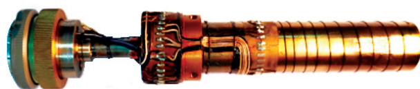
Рис. 2. Ампула тройной точки кислорода в сборе
