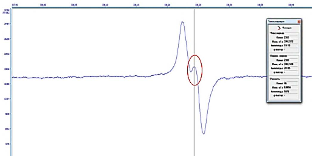
Рис. 2. Появление узкой линии в ЭПР-спектре кварца Морион при отклонении направления оси Z кристалла от направления магнитного поля в резонаторе
