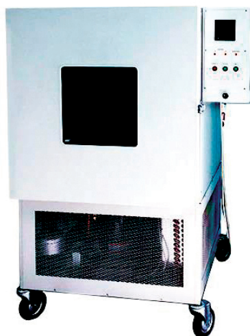
Рис. 2. Общий вид климатической испытательной камеры тепло-влаги-холода М-70/150-1000КТВХ (диапазон воспроизведения температуры воздуха — от –70 до 150 °С)
