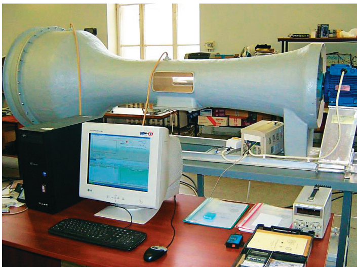
Рис. 1. Общий вид портативной аэродинамической трубы ПАТ-60 (скорость воздушного потока — 0,1–60 м/с)
