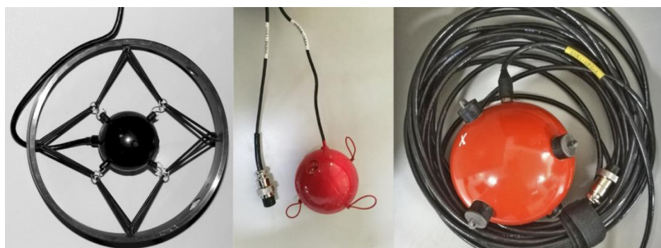
Рис. 2. Опорные ПКС: КГП-10 в крепёжном кольце (слева), VHS56 (посередине), VHS90 (справа)
