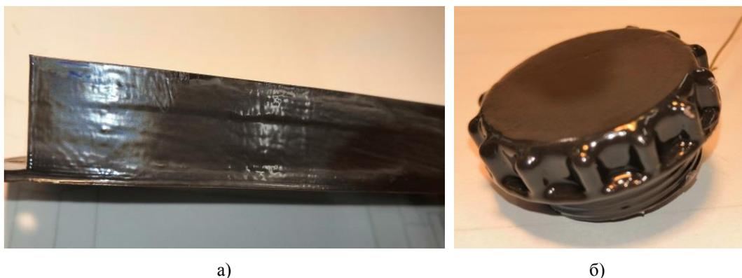
Рис. 1. Обработка деталей хлороформом: а — нанесение хлороформа кисточкой; б — погружение детали в пары хлороформа
