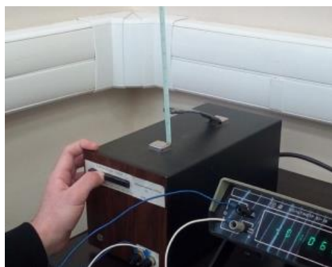
Рис. 2. Измерительная установка по испытаниям термопреобразователей
