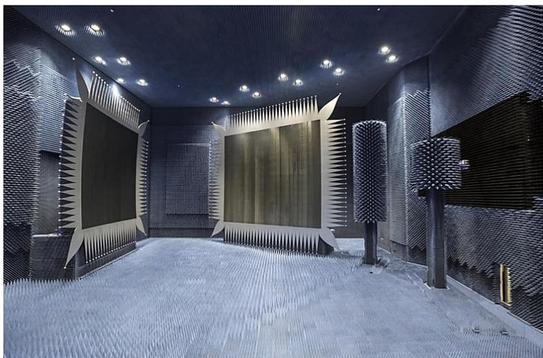
Рис. 3. АИВК на основе двухзеркального коллиматора с размером основного зеркала  $10 \times 12$  м и рабочей зоной диаметром 8 м
