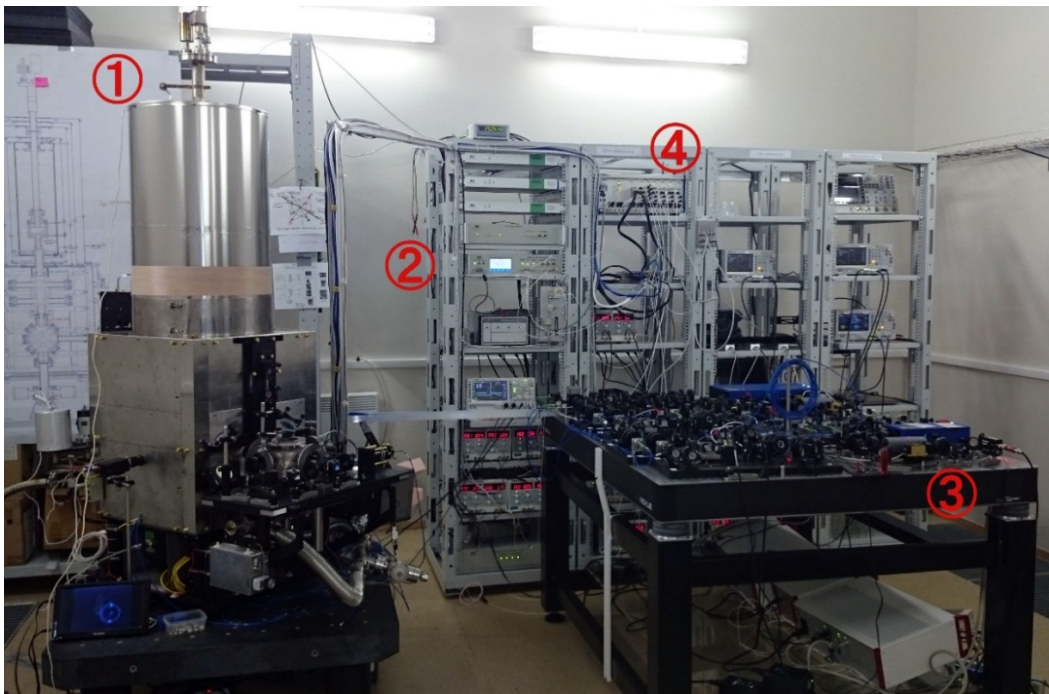
Рис. 1. Рубидиевый «фонтан»: 1 — атомный спектроскоп; 2 — система формирования зондирующего сигнала; 3 — лазерно-оптическая система; 4 — система управления
