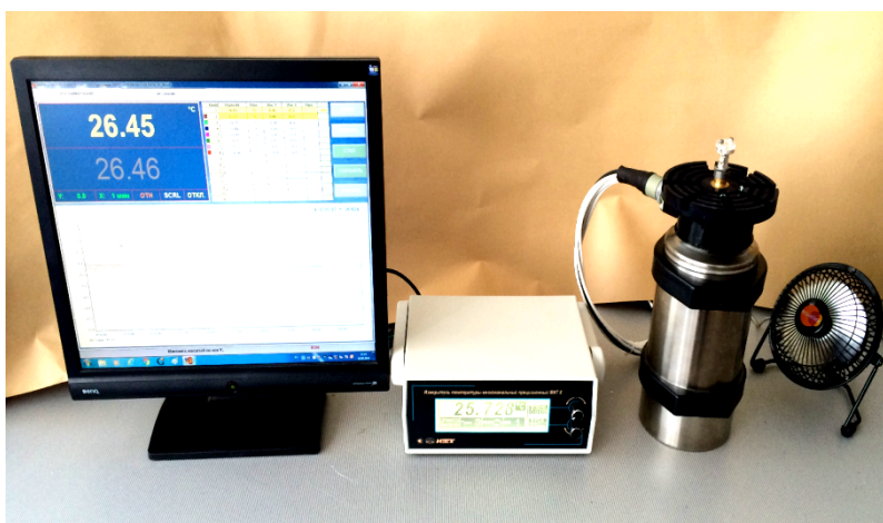
Рис. 9. Измерение распределения температуры вдоль теплоизолирующей линии НГШ при помощи МИТ8.10
