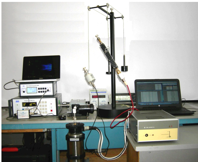
Рис. 6. Внешний вид макета измерительного тракта компаратора от 170 до 220 ГГц
