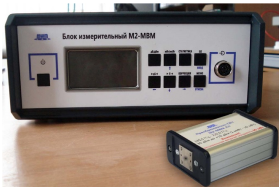
Рис. 5. Внешний вид и основные метрологические и технические характеристики измерителя мощности М2-МВМ-220
