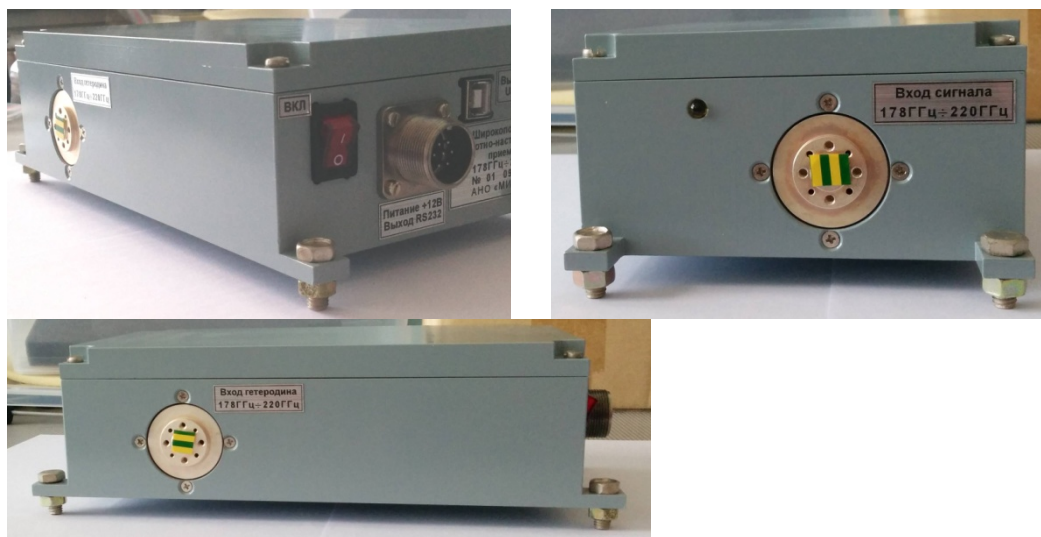
Рис. 2. Радиометр, (разъем питания, выходы RS232 и USB, входы сигнала и гетеродина 178 – 220 ГГц)
