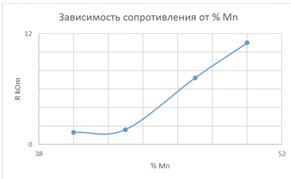
Рис.7. Зависимость сопротивления от количества марганца при прямом смешивании оксидов
