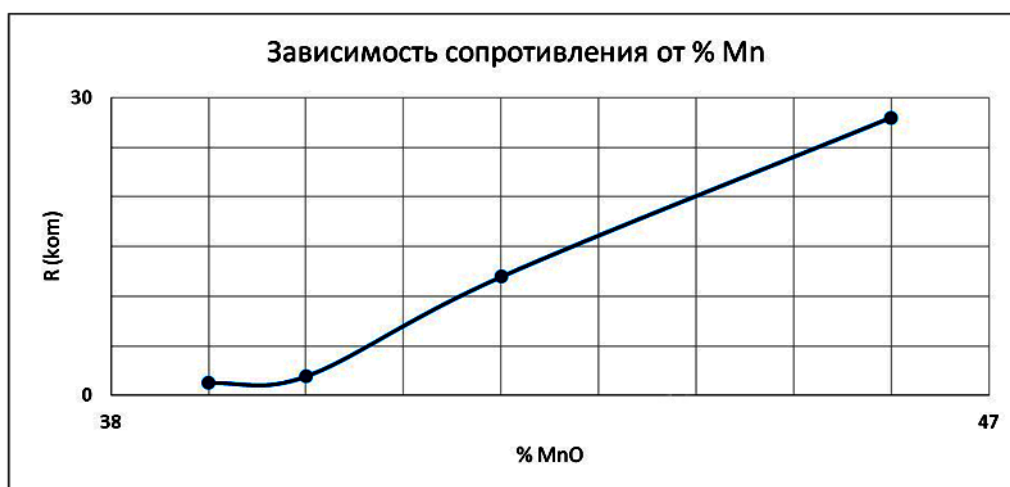
Рис.13. Зависимость сопротивления от количества марганца Поверхность заготовки термистора однородная (рис.14)
