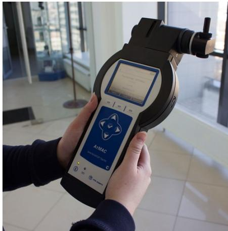
Неоспоримый плюс данного метода заключается в отсутствии зависимости показаний от физико-химических свойств измеряемой пыли.
