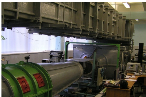
Рис. 7. Лазерный доплеровский анемометр ЛАД-015 и аэродинамическая установка АДС 700/100 из состава ГПСЭ
