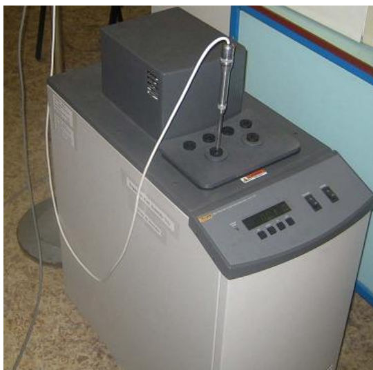
Рис. 10. Установка для воспроизведения температуры тройной точки воды
