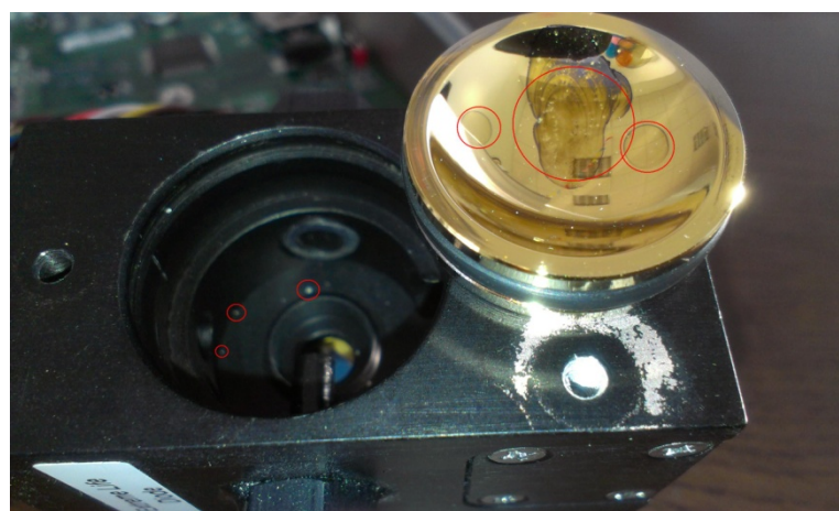
Рис. 4. Области загрязнения камеры ручного счетчика частиц
