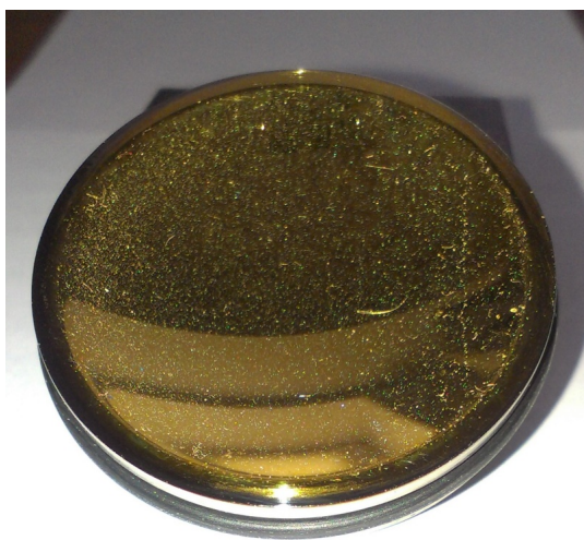
Рис. 3. Слой пыли и отдельные волокна на зеркале оптической камеры счетчика частиц
