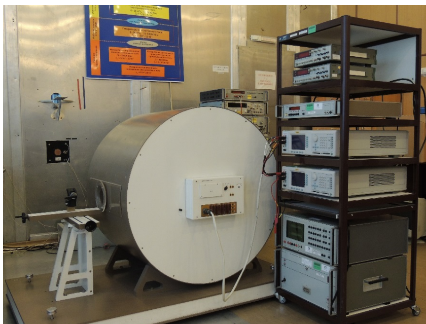
Рис. 1. Общий вид эталонного генератора электрического поля ГЭТ 158-96. Слева — эталонный экранированный конденсатор КПЭ1
