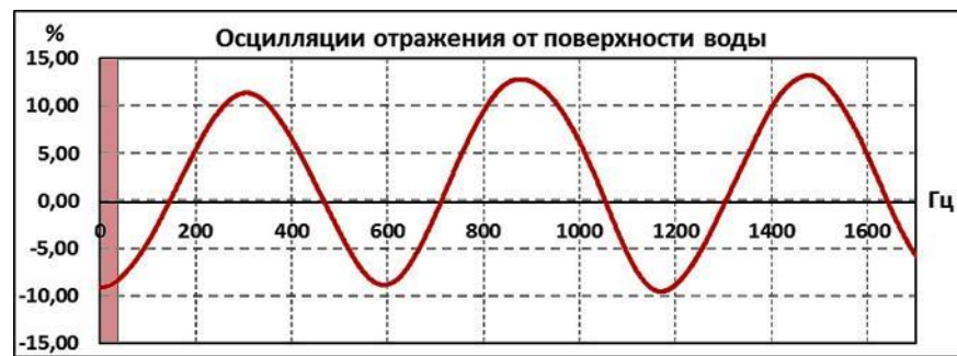
Рис. 23. Функция осцилляции отражения от границы раздела вода — воздух
