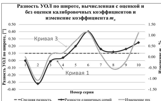
Рис. 3. Значения калибровочных коэффициентов m_x и m_y и их изменение в течение наблюдений в одной точке
