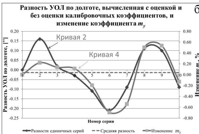
Рис. 4. Разности УОЛ, вычисленные с оценкой калибровочных коэффициентов для каждой серии и без их оценки, и изменение коэффициентов: а — по широте и m_x ; б — по долготе и m_y
