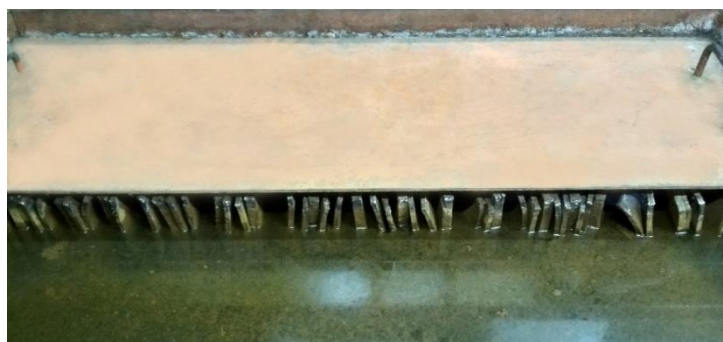
Рис. 2. Установка элементов заглушения с воздушным зазором на поверхности ГАБ
