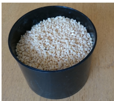
Рис. 4. Внешний вид объемных насыпных источников: а) в чашке Петри, б) в сосуде Маринелли
