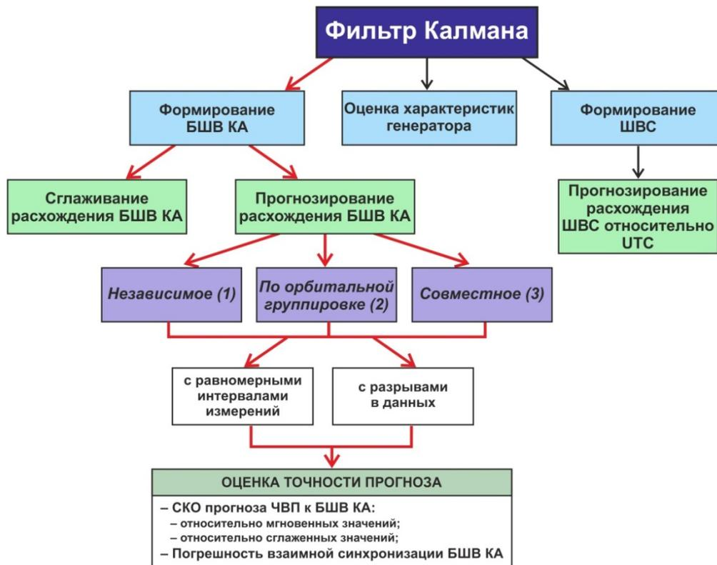
Рис. 1. Области возможного применения фильтра Калмана в частотно-временном обеспечении ГЛОНАСС
