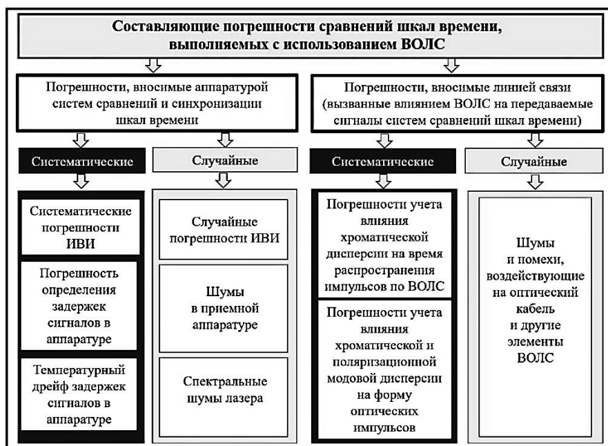
Рис. 4. Классификация составляющих погрешности сравнений шкал времени, выполняемых с использованием ВОЛС
