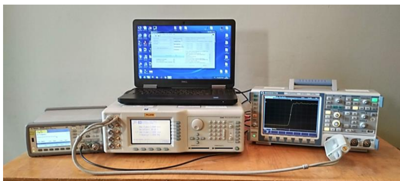
Рис. 2. Фотография АИС в процессе поверки осциллографа цифрового С8-205/4
