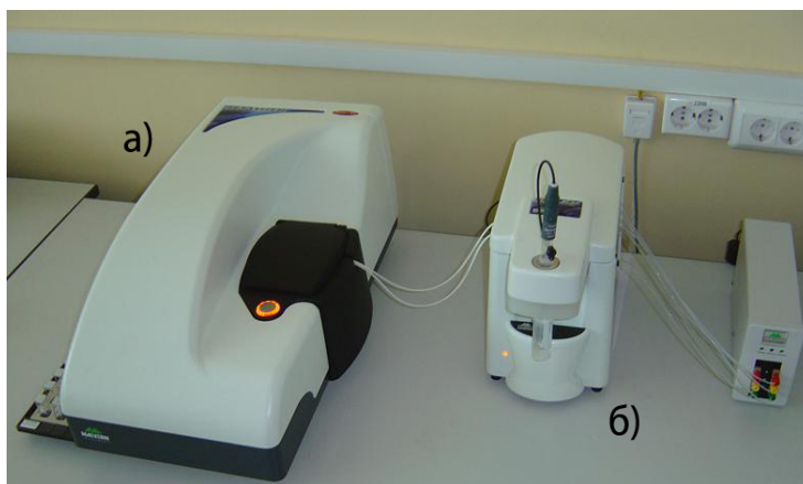
Рис. 5. Внешний вид аппаратуры в составе вторичного эталона: а) анализатор размеров частиц типа Malvern Zetasizer Nano ZS, б) автотитратор типа МРТ-2
