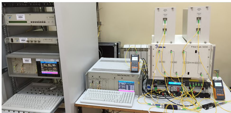
Рис. 29. Схема и общий вид установки. ВГ - водородный стандарт времени и частоты; ПК - персональный компьютер управления; SATRE – Модем SATRE; ОТ - оптический трансмиттер; ОР - оптический ресивер; ОИ - оптический изолятор; Ц – Циркулятор; ОА - оптический аттенуатор; ОУ - оптический усилитель
