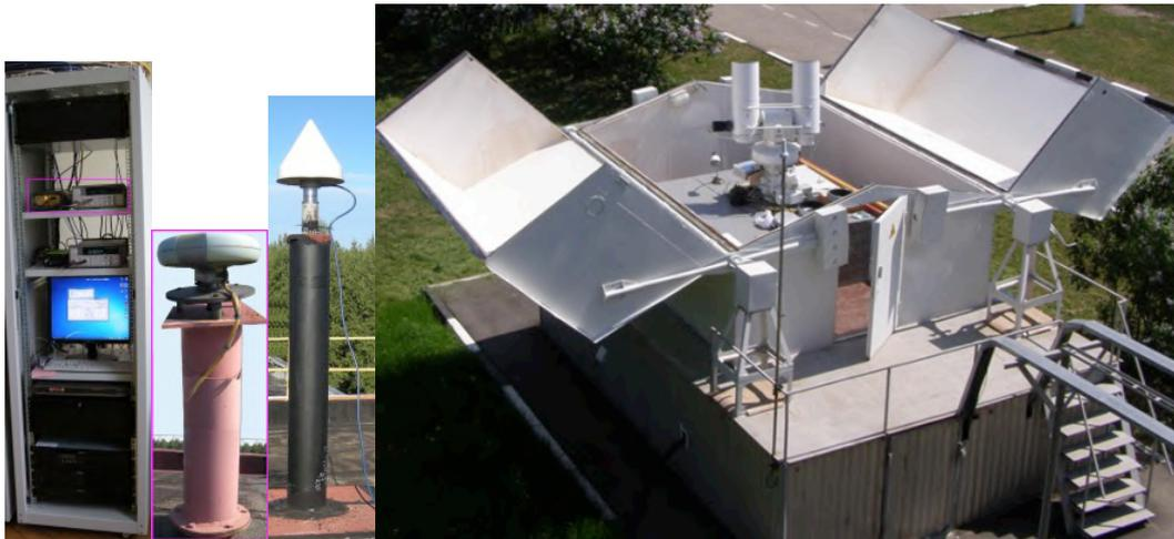
Рис. 8. Навигационная измерительная аппаратура пункта определения ПВЗ ГМЦ ГСВЧ (слева) и СЛД «Сажень-ТМ» (справа)
