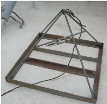
Рис. 25. Донная установка гидрофона в соответствии с рекомендациями DNV [12]
