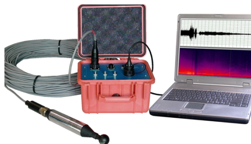
Рис. 24. Цифровой гидрофон с блоком управления и ПК [21]
