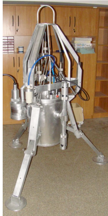
Рис. 26. Подводная система IGLOO для измерения шума на мелководье [23]
