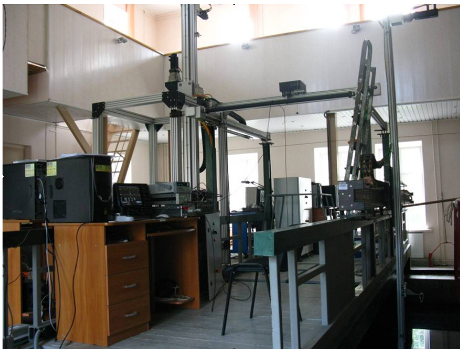
Рис. 5. Измерительная установка для реализации градуировки по полю методом СКВУ на ЛЧМ сигналах
