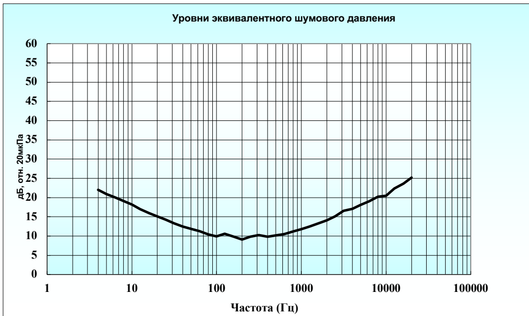
Рис. 8. Уровни электрической составляющей эквивалентного шумового давления в третьооктавной полосе частот гидрофона ГИ50Э
