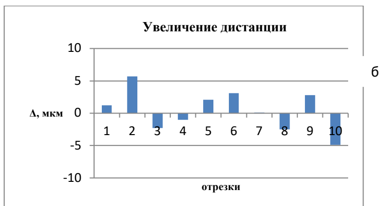
Рис. 10. Разность показаний между ИЛТ и Renishaw, измеренные в один день при а) уменьшении и б) увеличении дистанции
