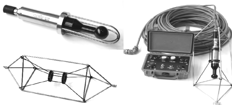
Рис.19. Приспособления для работы гидрофона в морских условиях
