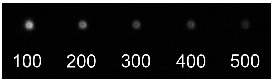
Рис.20. Фотографии облака вторично охлажденных атомов Sr для различных моментов детектирования t_u , цифры – значения t_u (в мс)
