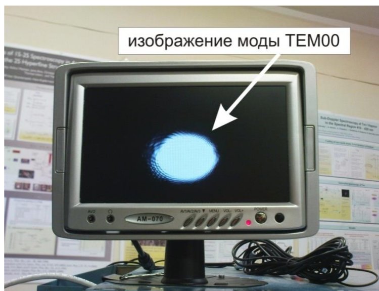
Рис.18. Изображение моды TEM 00 в состоянии, когда лазер привязан к резонатору
