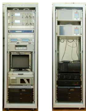
Рис.4. Комплекс формирования шкалы времени, приближенной с заданной точностью к Национальной шкале времени UTC(SU), и передачи формируемой шкалы времени в НКУ ГЛОНАСС в реальном масштабе времени
