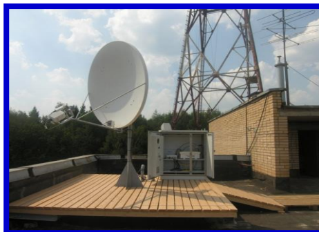
Рис. 2. Комплекс дуплексных сличений шкал времени (мобильная и стационарная составляющая)
