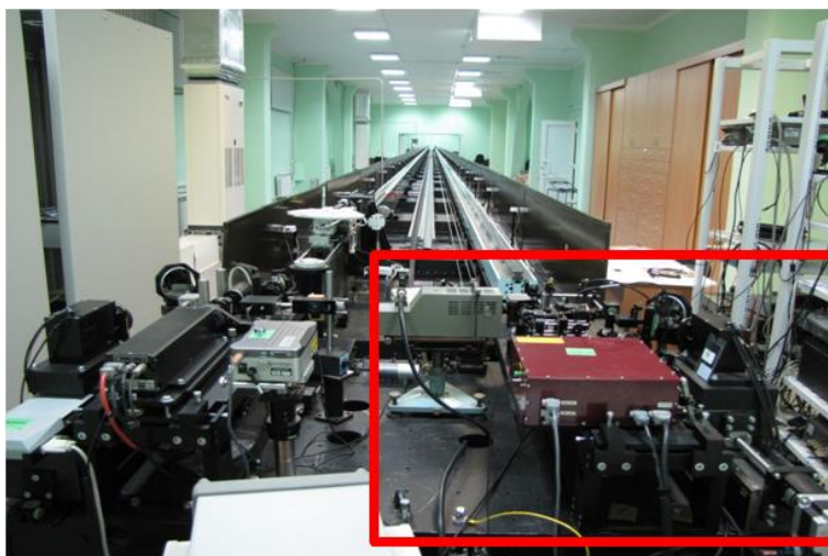
Рис. 19. Макет стационарного комплекса до 60 м. на основе фемтосекундного лазера
