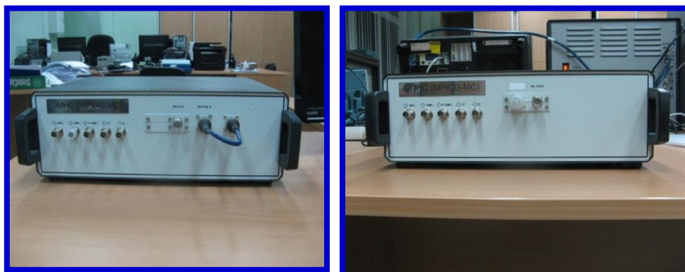
Рис.7. Эталонный источник навигационных сигналов и эталонный приемник навигационных сигналов
