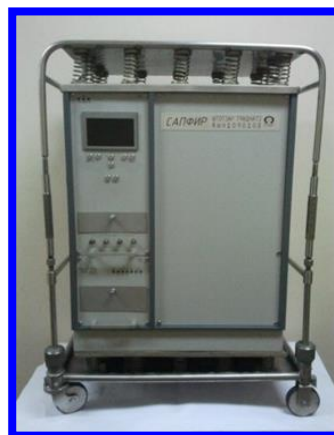
Рис.3. Эталон-переносчик единиц времени и частоты (в мобильной лаборатории и отдельно)
