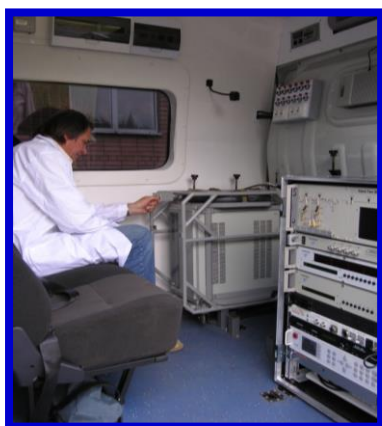
Рис.3. Эталон-переносчик единиц времени и частоты (в мобильной лаборатории и отдельно)
