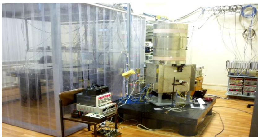
Рис.1. Метрологический цезиевый репер частоты типа “Фонтан”
