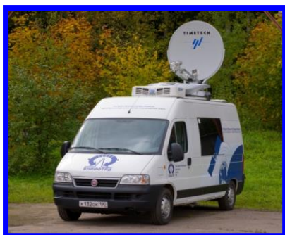
Рис. 2. Комплекс дуплексных сличений шкал времени (мобильная и стационарная составляющая)
