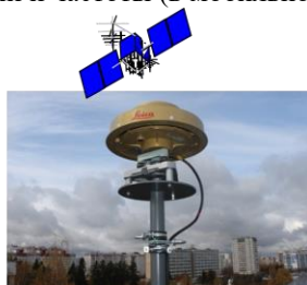
Рис.3. Эталон-переносчик единиц времени и частоты (в мобильной лаборатории и отдельно)
