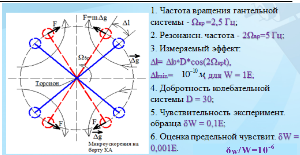
Рис. 2. Вращающиеся градиентометры гантельного типа
