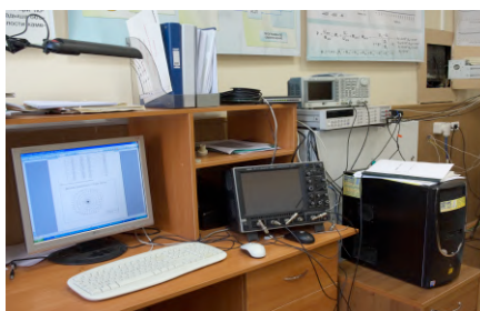
Рис. 3. Установка на частоты 200 – 500 кГц: рабочее место оператора и приборная стойка на фоне малого бассейна
