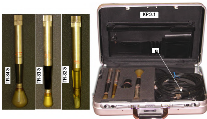
Рис. 6. Гидрофоны ГИ-32 Э, ГИ-33 Э, ГИ-34 Э и кабели к ним (а)
