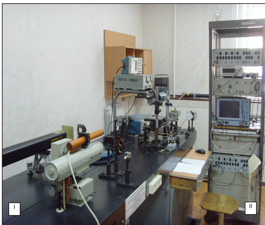
Рис. 1. Внешний вид эталонной установки для воспроизведения единиц скоростей распространения продольных и сдвиговых ультразвуковых волн.
