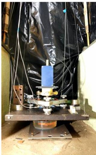
Рис.3. Внешний вид антисейсмической платформы с акселерометрами
