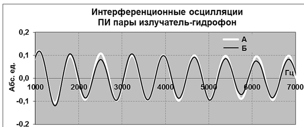
Рис. 5. Интерференционные осцилляции ПИ пары излучатель—гидрофон при размещении пары по схеме А и Б
