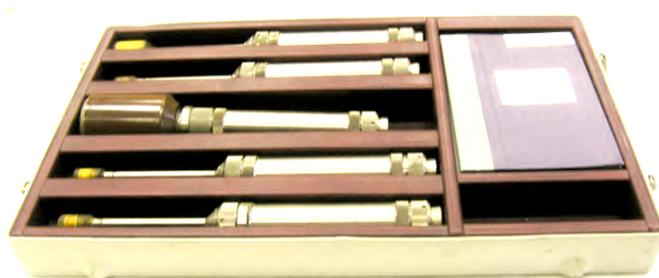
Рис. 19. Один из вариантов комплекта поставки гидрофонов для ГКУ-75
