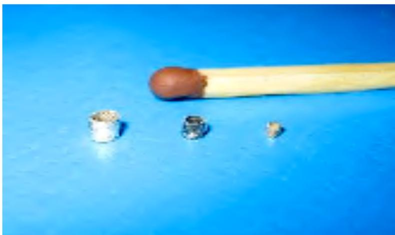
Рис.39. Пьезокерамические цилиндрические элементы с радиальной поляризацией диаметром 2, 1,5 и 1 мм
