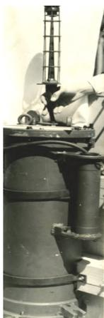
Рис.2. Фото гидрофона 1ПН-2 с блоком предварительных усилителей.
