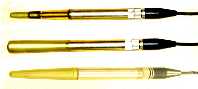
Рис. 36. Гидрофоны ГИ-31, ГИ-35 и ГИ-36 (сверху вниз) из комплекта КОГ-1
