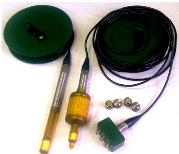
Рис. 26. Комплект измерительных гидрофонов КИГ-2
