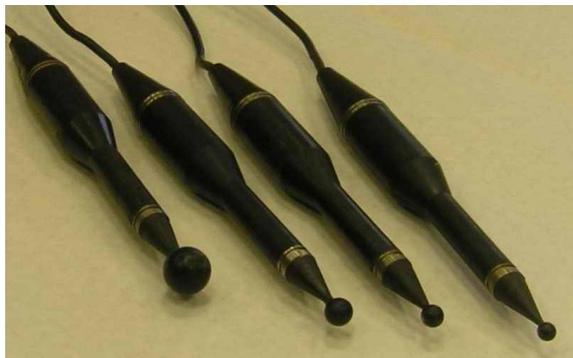
Рис. 27. Внешний вид гидрофонов ГИ-7, ГИ-10, ГИ-8 и ГИ-9 (слева направо)
