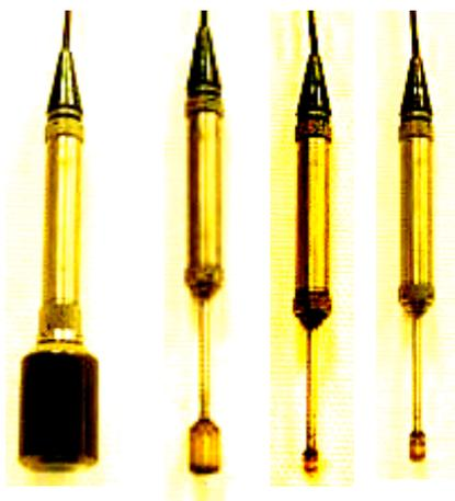
Рис. 18. Гидрофоны ГИ-1, ГИ-2, ГИ-3 и ГИ-4
