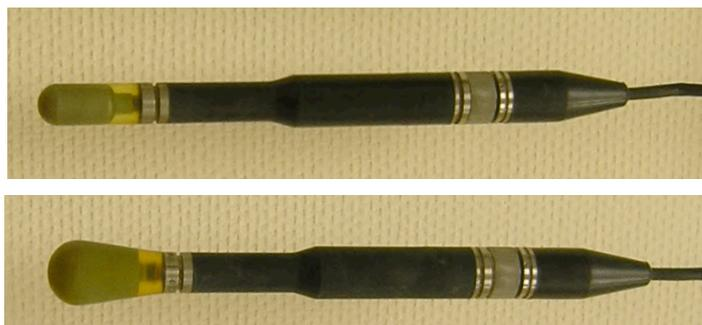
Рис. 31. Гидрофоны ГИ-20 (внизу) и ГИ-21
