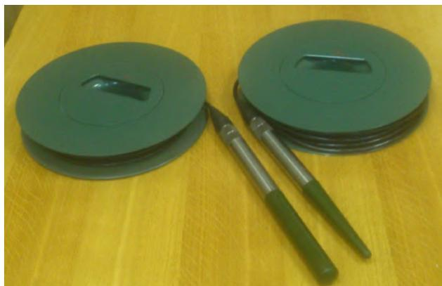
Рис. 21. Гидрофоны выставочного комплекта КИГ
