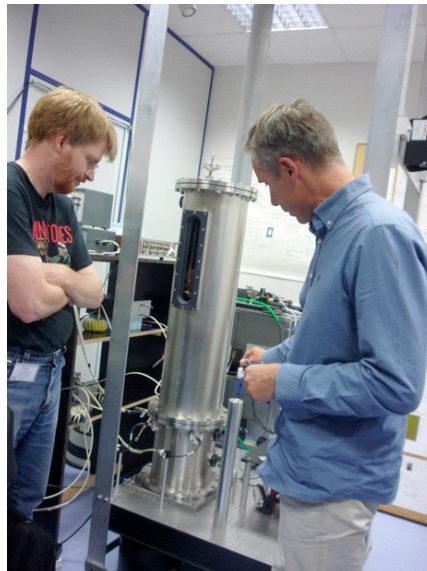
Рис. 4. Установка для воспроизведения единицы СИ электрической величины на основе расчётного конденсатора
