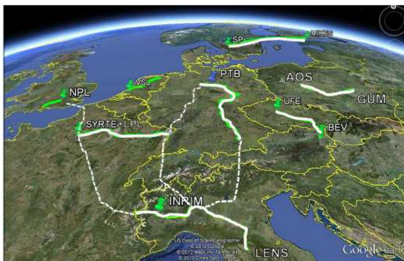
Рис. 10. Существующие (сплошные) и рассматриваемые (пунктирные) оптические каналы для обеспечения сличений по времени и частоте
