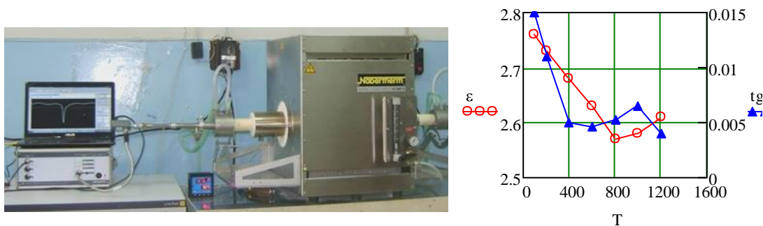
Рис. 11. Установка ИРТХ и температурные зависимости \varepsilon и \text{tg}\delta высокотемпературного материала
