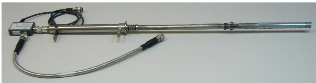
Рис. 10. Высокотемпературный измерительный преобразователь с датчиком КСВ
