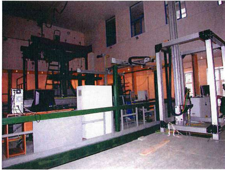
Установка с гидроакустическим бассейном для диапазона частот от 1,0 до 250 кГц
