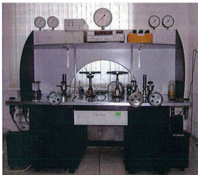
Государственный первичный эталон единицы давления в диапазоне 10–1600 МПа и эффективной площади поршневых пар грузопоршневых манометров в диапазоне 0,05–1 см 2 ГЭТ 43-2013
