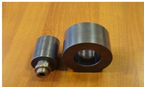
Рис. 8. Поршневая пара с диаметром поршня 60 мм
