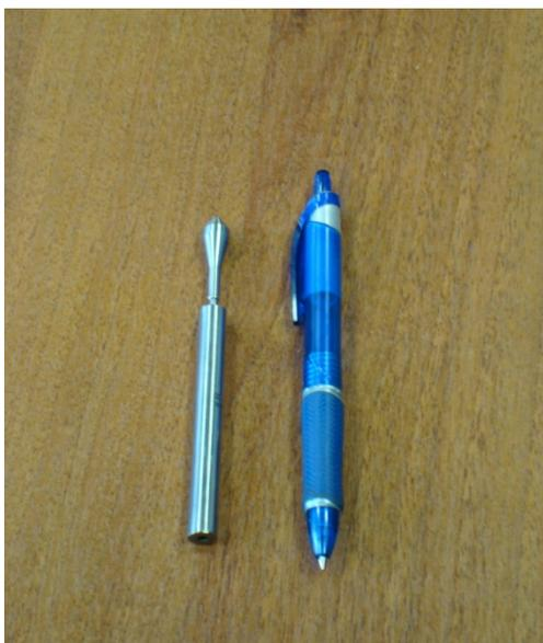
Рис. 7. Поршневая пара высокого давления из твердого сплава
