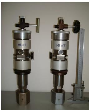
Рис. 6. Измерительный мультипликатор «Мультибар»
