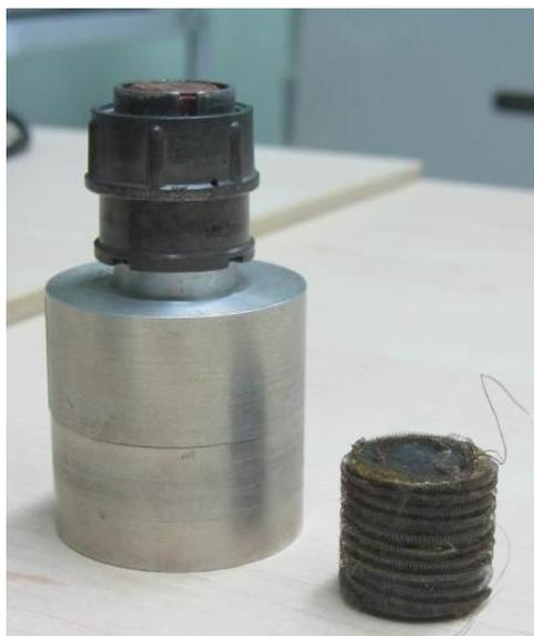
Рис. 5. Калориметр интегрального теплового потока с поглотителем из графита КТП-ГР-γ для воспроизведения единицы мощности поглощенной дозы фотонного излучения с энергией 0,66 МэВ (гамма-излучение Cs-137) и 1,25 МэВ (гамма-излучение Co-60) в графите
