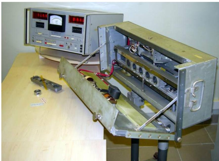
Рис. 7. Транспортируемая калориметрическая установка «ТКУГ-е» с дифференциальным калориметром теплового потока с поглотителем из графита КТП-е для воспроизведения единицы мощности поглощенной дозы электронного излучения в графите в диапазоне энергий от 3 до 10 МэВ
