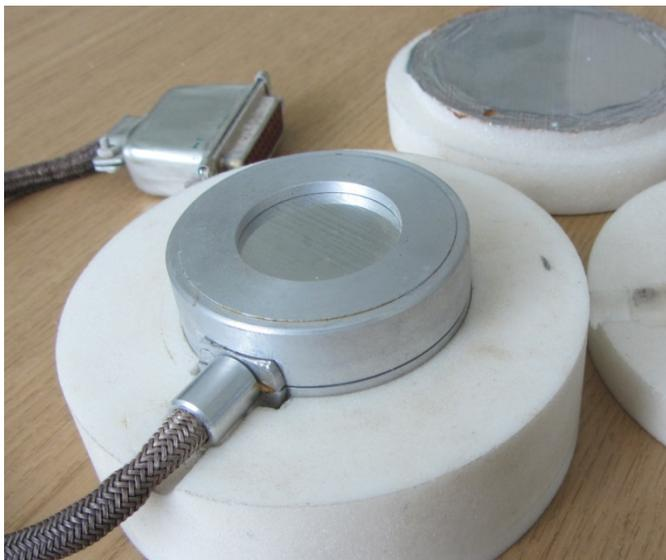
Рис. 6. Калориметр интегрального теплового потока с поглотителем из графита КТП-β для воспроизведения единицы мощности поглощенной дозы бета-излучения с граничной энергией 2,26 МэВ (бета-излучение Sr-90 + Y-90)
