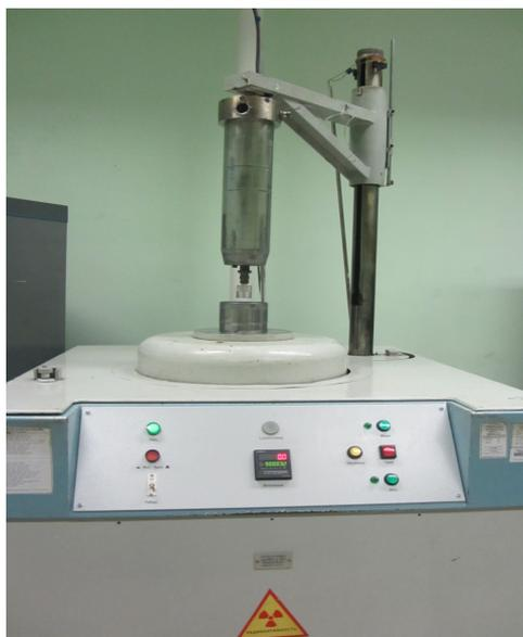
Рис. 8. Самозащищенная установка «MPX-гамма-100» (содержит 36 радионуклидных источников Co-60 активностью по  $1000 \div 1100$  Ки)
