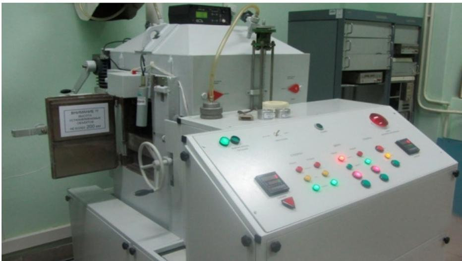
Рис. 10. Самозащищенная бета-установка БОИС-3 (содержит 1 радионуклидный источник Sr-90 + Y-90 активностью 800 Ки)
