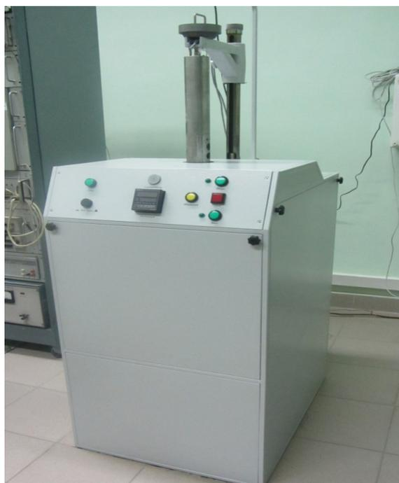
Рис. 9. Самозащищенная установка «ЛМБ-гамма-1м» (содержит 24 радионуклидных источника Cs-137 суммарной активностью 3600 Ки).
