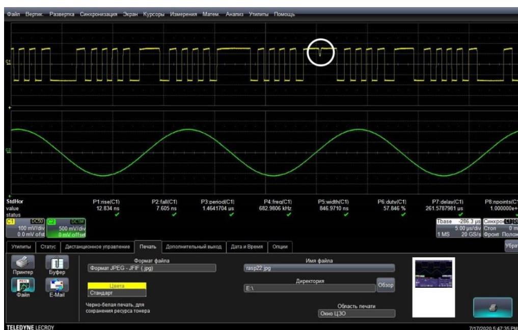
Рис. 3. Осциллограмма ЧМ импульсов с изменением амплитуды импульса
